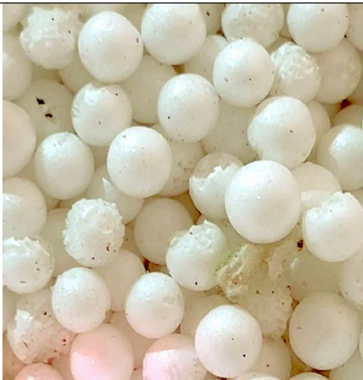
Рисунок 5 — Полистироловые гранулы, поврежденные и частично фрагментированные личинками Zophobas morio (фотография сделана после одних суток инкубации)
