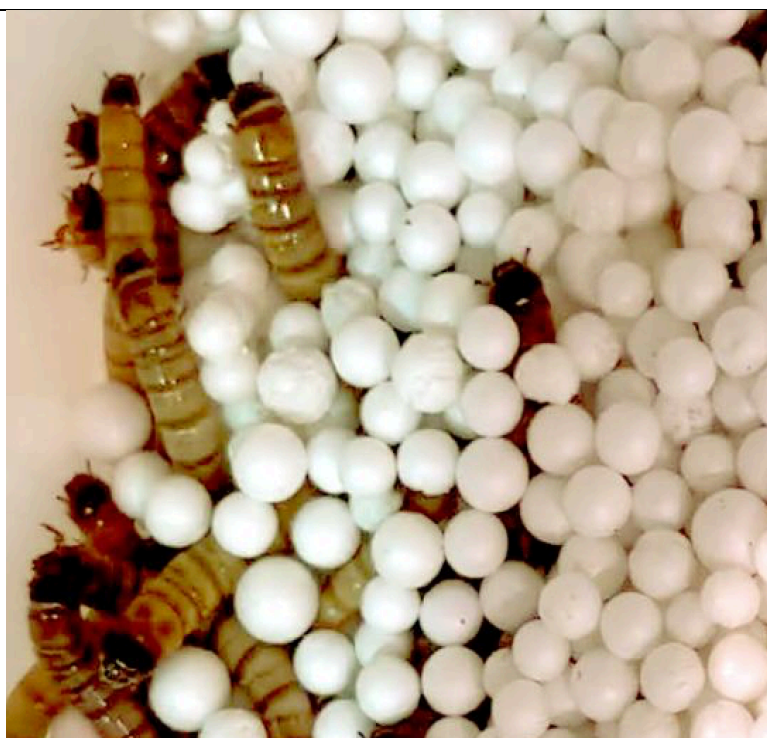
Рисунок 4 — Личинки Zophobas morio измельчают и перерабатывают полистироловые гранулы в экспериментальной установке. Фотография сделана непосредственно после помещения личинок в субстрат
