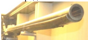
винтовой нарез ствола
