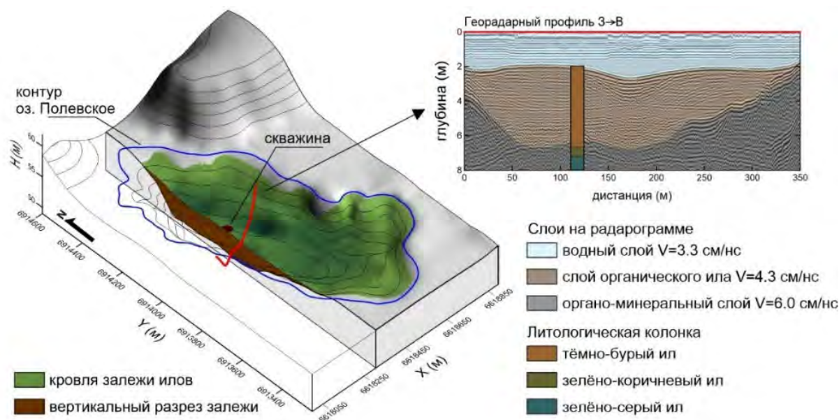
Рис. 2 Модель залежи органических илов оз. Полевское с примером интерпретации георадарных данных по отдельному профилю
