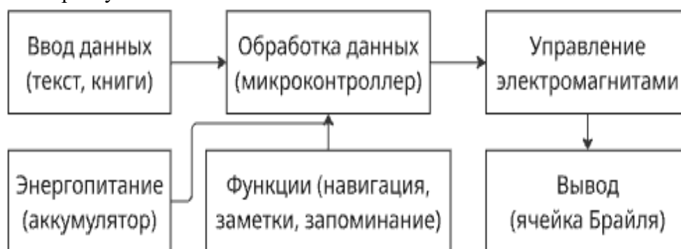
Рисунок 2. Функциональная схема работы системы дисплея
