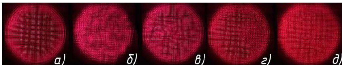
Рис. 2. Тальбограммы: без возмущений (а), спустя 5 секунд после добавления горячей воды (б), спустя 10 секунд после добавления горячей воды (в), спустя 5 секунд после добавления соли (г), спустя 10 секунд после добавления соли (д)
