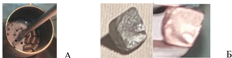
Рисунок 1. Таблетки диоксида урана: А- до металлизации (в танталовой корзине-валу мешалки) и Б-после металлизации и раскусывания кусачками.
