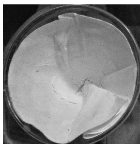
Рисунок 1. Внешний вид оксалата америция
