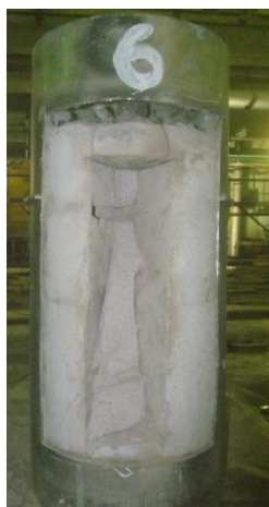
Рисунок 1. МКФ компаунд с 12,5% включением ТХО ОИОС
