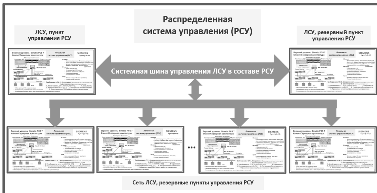
Рис. 1. Структурно-функциональная модель РСУзи ФЛРС
