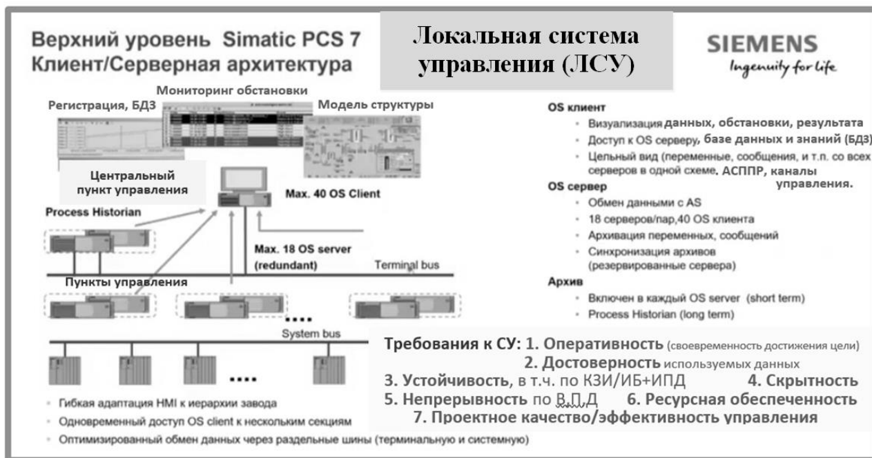
Рис. 2. Структурно-графическая модель ЛСУ из состава РСУзи ФЛРС
