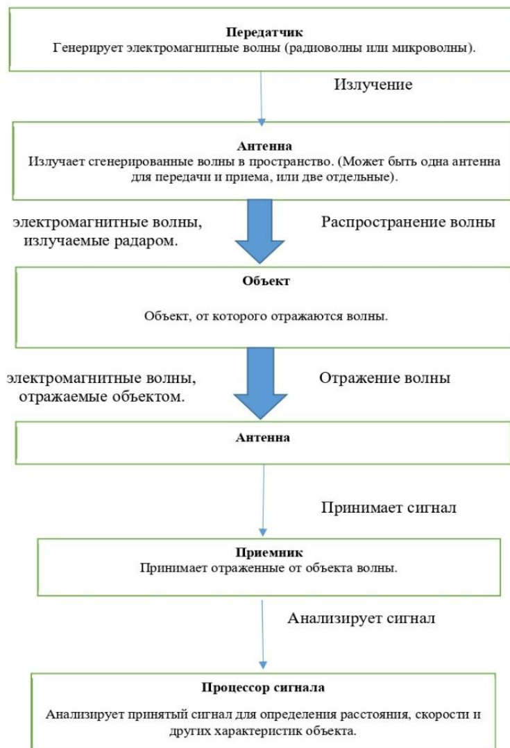
Рис. 1. Структурная схема работы радара [6].
