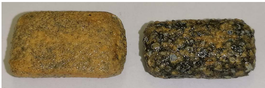
Рис. 1. Внешний вид образцов графита с покрытиями. Слева состав 1, 1200 °С 4 ч, справа состав 2, 1300°С 4 ч (неизотермический режим).
