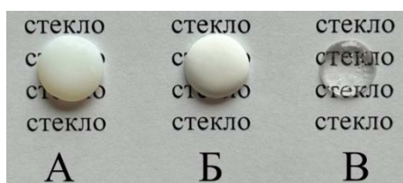
Рис.1. Фотографии полимерного композита (А), образца после удаления полимерного связующего (Б) и стекла после спекания (В).
