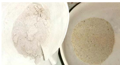
Рис. 1. Слева - нерастворимый остаток на бумажном фильтре после промывки дистиллированной водой термообработанной смеси гидроксида натрия и кварцевого песка, масс.% ( \text{Na}_2\text{O} -3; \text{SiO}_2 -97). Справа – кварцевый стекольный песок до активации.
