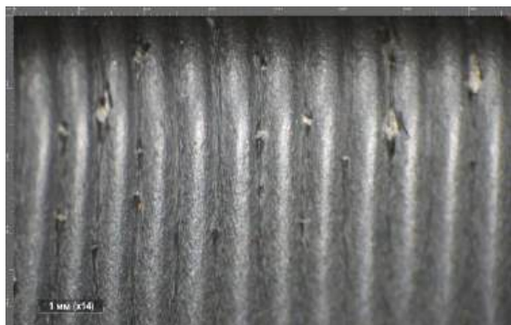
Рисунок 2. Разрывы лакокрасочного покрытия в зоне морщин
