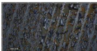
Рисунок 4. Разрушение лакокрасочного покрытия и коррозия после стерилизации в 3% растворе пищевой соли Figure 4. Destruction of paint coating and corrosion after sterilization in 3% solution of edible salt
