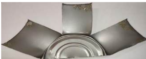
Рисунок 5. Внутренняя поверхность банки № 5 после стерилизации в 3% растворе уксусной кислоты
