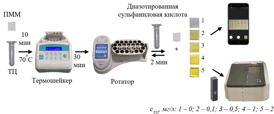
Рисунок 1. Схема определения ТЦ с использованием полиметакрилатной матрицы
