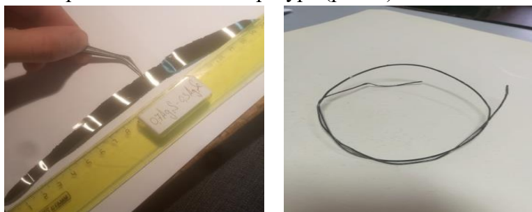
Рис.1. Фольга и проволока, полученные холодной прокаткой сплавов системы \text{Ag}_2\text{S-Ag}_2\text{Se} [2].
