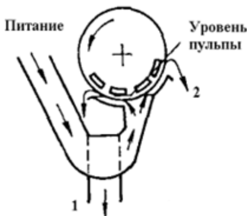
Рис. 1. Схема магнитного сепаратора для мокрого обогащения
