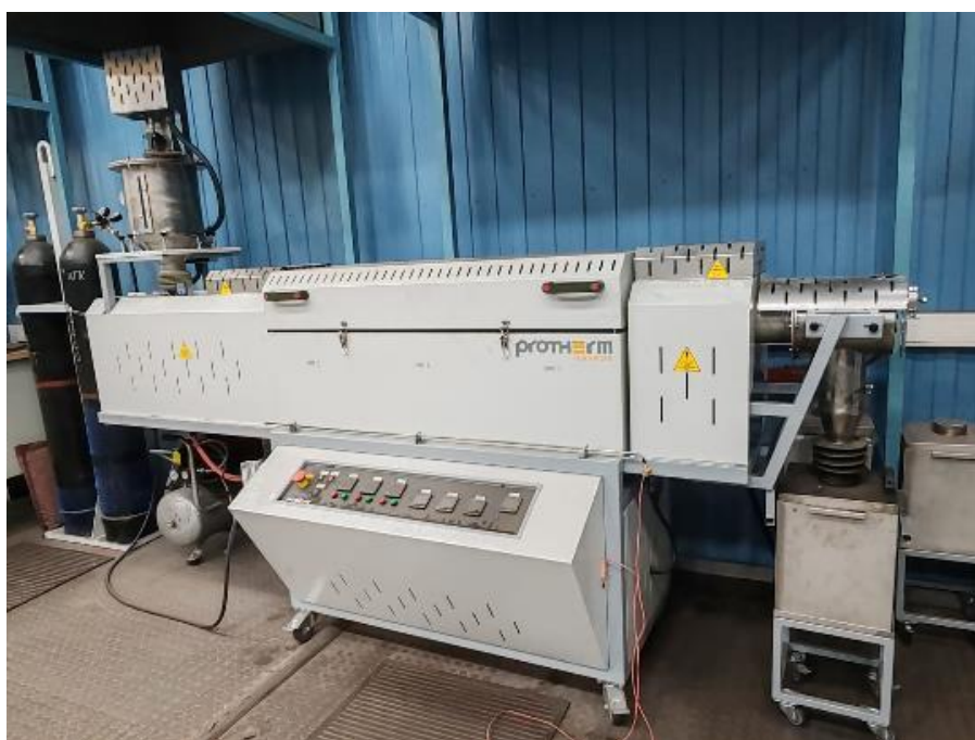
Рисунок 1. Трубчатая вращающаяся печь косвенного нагрева Protherm
