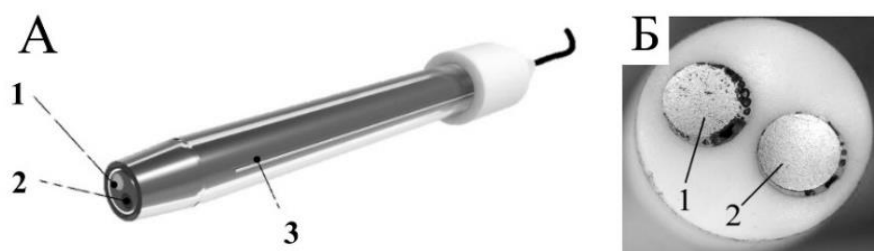
Рис.1. Датчик «3в1»: (А) – общий вид и (Б) – фотография рабочей поверхности: 1 – рабочий электрод (импрегнированный графит), 2 – вспомогательный электрод, 3 – электрод сравнения
