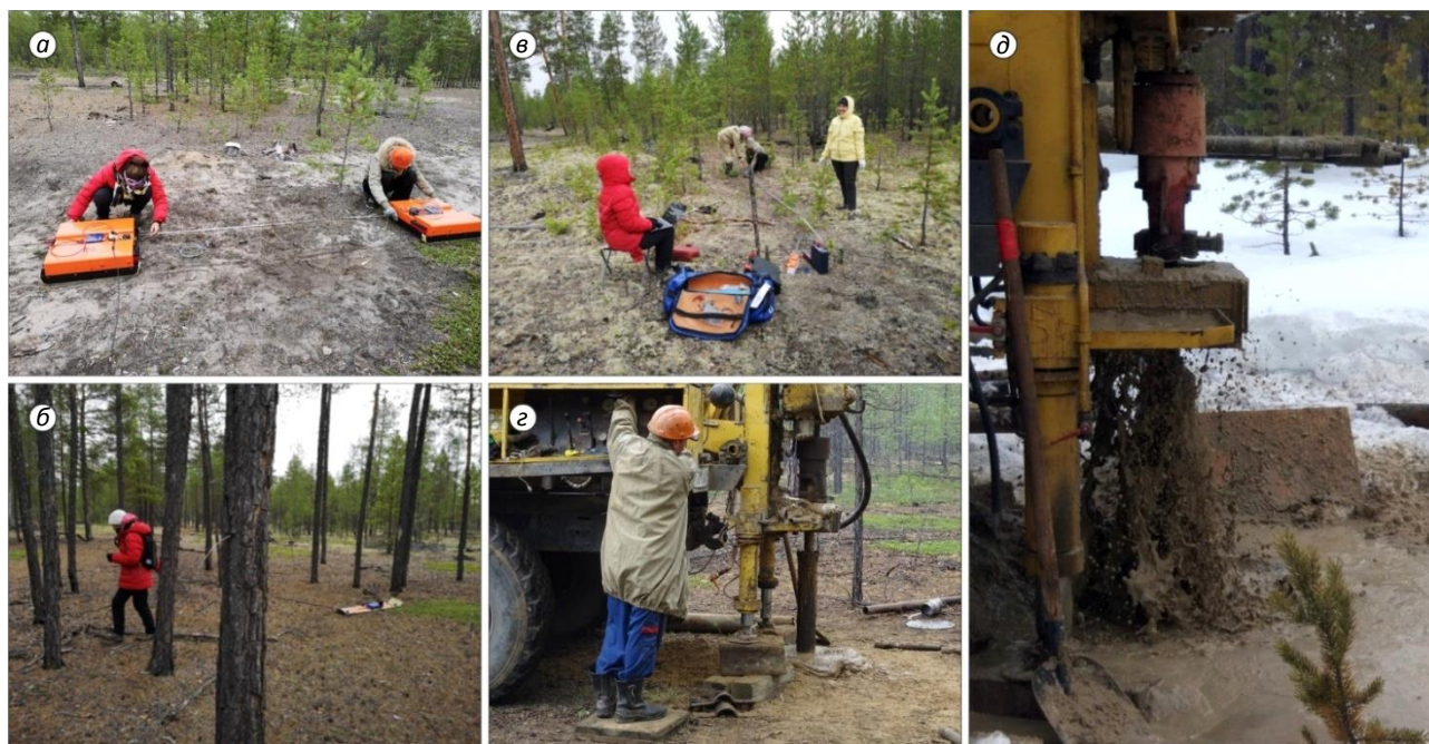
Рис.2. Ход выполнения ОГТ (а), георадарных (б), электроразведочных (в) работ, бурения (г) и фонтан воды, бьющий из пробуренной скважины (д)
