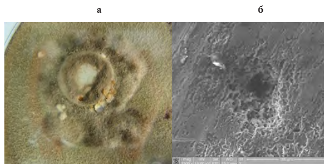
Рисунок 1. Обрастание грибом Penicillium chrysogenum образца алюминий-магниевого сплава (А) и вызываемое им в результате обрастания в течение месяца в смоделированных условиях коррозионное повреждение поверхности образца алюминий-магниевого сплава (Б, изображение получено на электронном микроскопе ZEISS EVO MA10 (Германия) [1].
