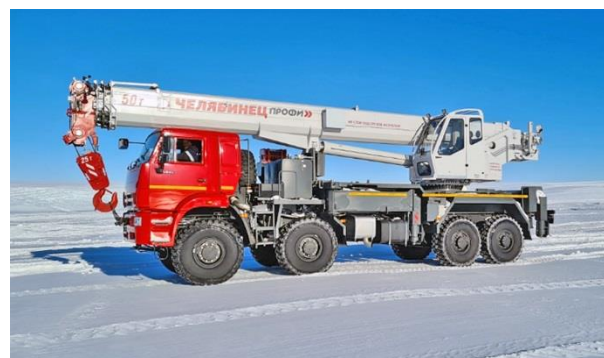
Рис.3. Фрагмент уплотнения снежного слоя с помощью уплотняющей платформы (а) и автомобиль-кран, используемый в качестве тестовой тележки для проверки прочности покрытия аэродрома (б)
