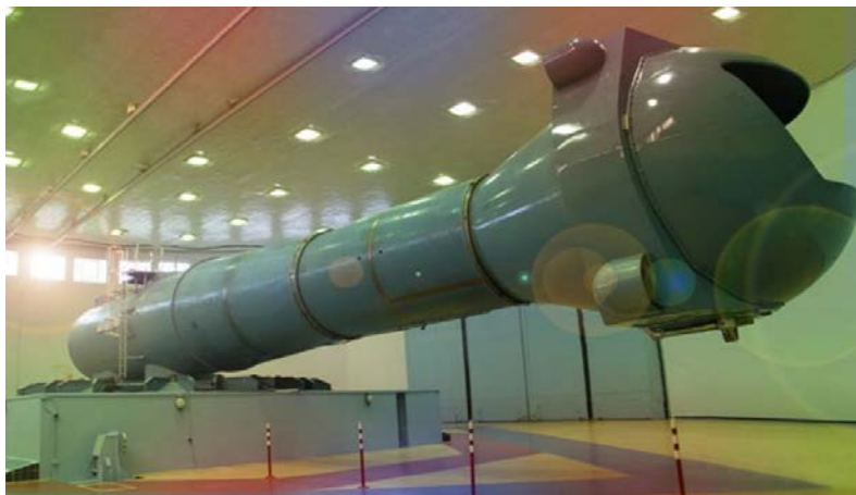
Рисунок 1 – Центрифуга ЦФ-18 для испытаний космонавтов на предельные нагрузки [www.gctc.ru]
