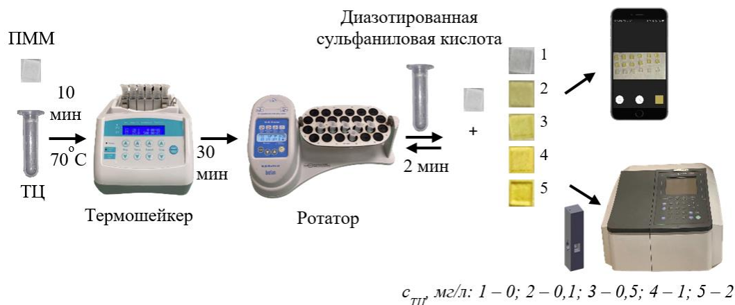
Рисунок 1. Схема определения ТЦ с использованием полиметакрилатной матрицы
