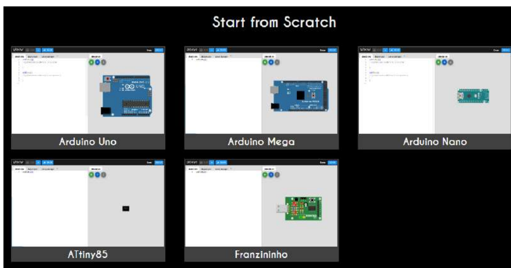
Рис. 6. Рабочее окно веб-приложения Wokwi.com с выбором микроконтроллера и многочисленных готовых проектов
