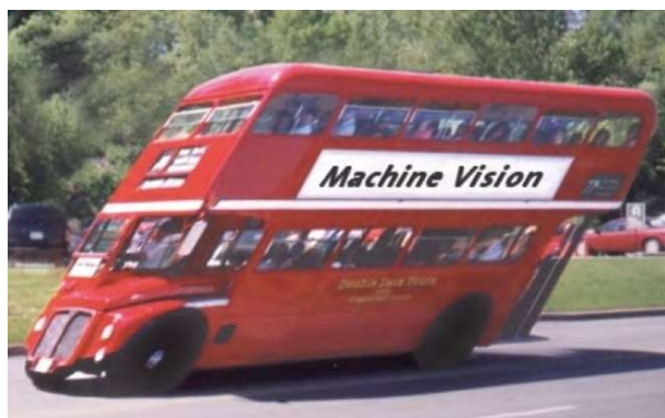
Рисунок 1. Искажения изображений в режиме rolling-shutter
