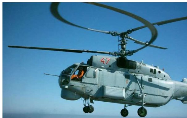
Рисунок 1. Искажения изображений в режиме rolling-shutter
