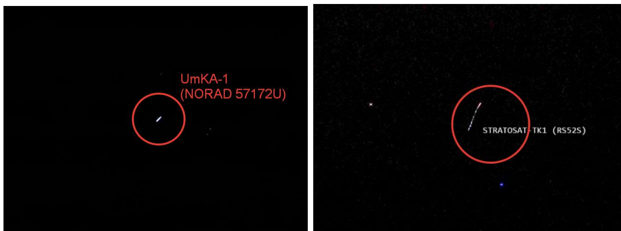
Рисунок 2. Примеры работы MIDE AstroPlanner. Слева – кубсат 3U UmKa-1, отснятый обзорной камерой ДЗЗ низкого разрешения кубсата 3U «Монитор-3» 01.07.2024, справа – кубсат 3U Stratosat-TK-1, отснятый с кубсата 3U «Монитор-4» 21.06.2024
