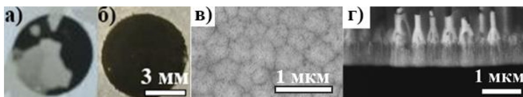
Рис. 2. Фотографии АОА с осаждѐнным палладием при напряжении 7 В при использовании в качестве темплата АОА без выдержки при 5 В (а) и с дополнительным анодированием при 5 В (б). РЭМ изображение нижней поверхности АОА (в) с осаждѐнным палладием при напряжении 5 В. РЭМ изображение скола (г) образца, представленного на панели (б).
