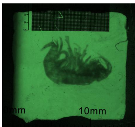
Рис. 1. Рентгеновское изображение, полученное на прототипе сцинтилляционного экрана на основе \text{TEA}_2\text{Mn}_{0.95}\text{Zn}_{0.05}\text{Br}_4 и ЭВА.
