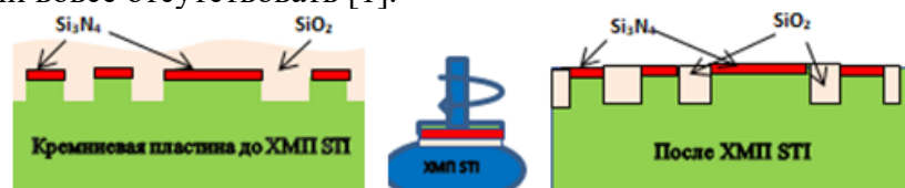
Рисунок 1–Схема реализации процесса ХМП STI
