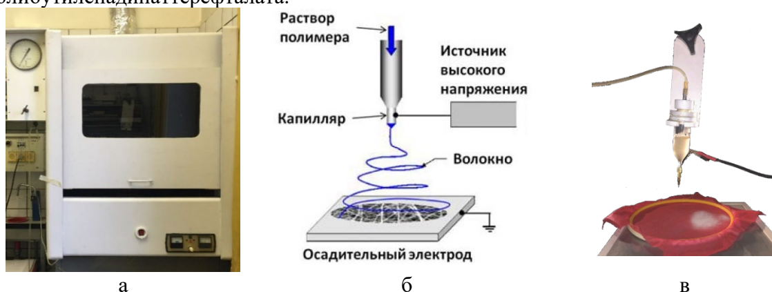
Рис. 1. Общий вид установки (а), схема процесса (б) и рабочий узел установки электроформования.
