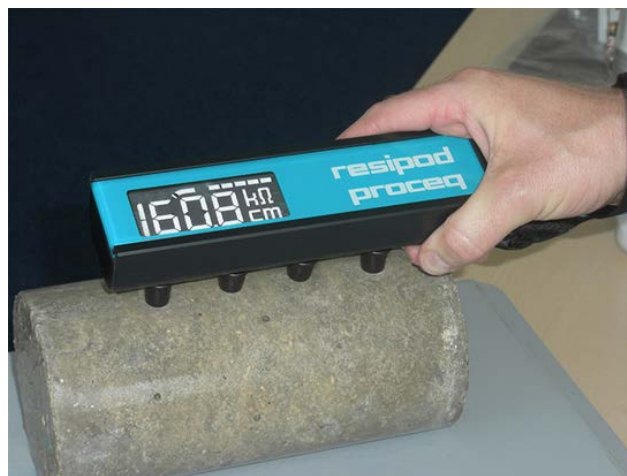
Фиг. 7. Изпитване на бетонов блок чрез уред за електрическо съпротивление.
