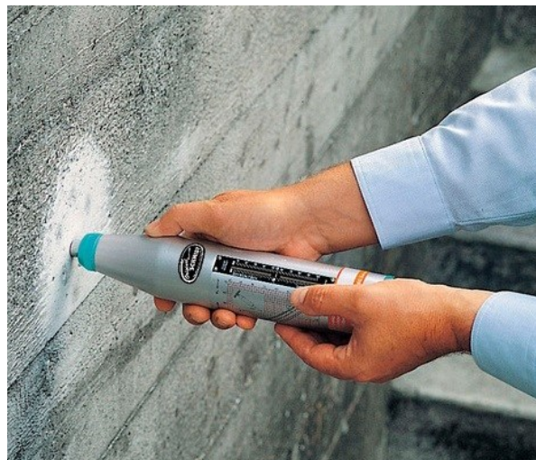
Фиг. 1. Диагностика чрез чук на Schmidt.
