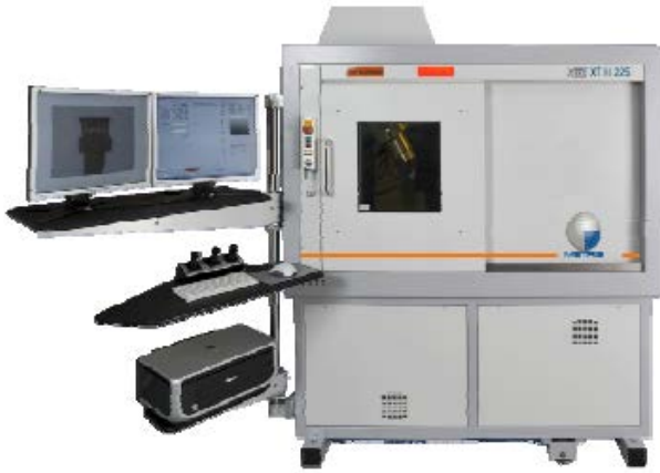
Фиг. 1. 3D индустриален компютърен томограф Nikon XT H 225.
