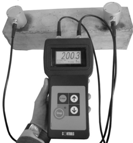
Фиг. 2. Диагностика чрез ултразвуков бетоноскоп.
