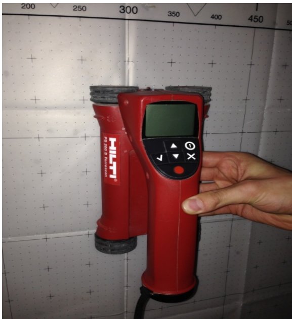
Фиг. 8. Измерване на покритието върху арматурата с вихрови токове.
