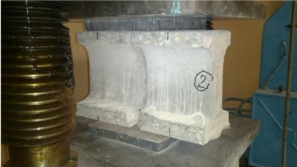
Рисунок 1 – Модель платформенного стыка
