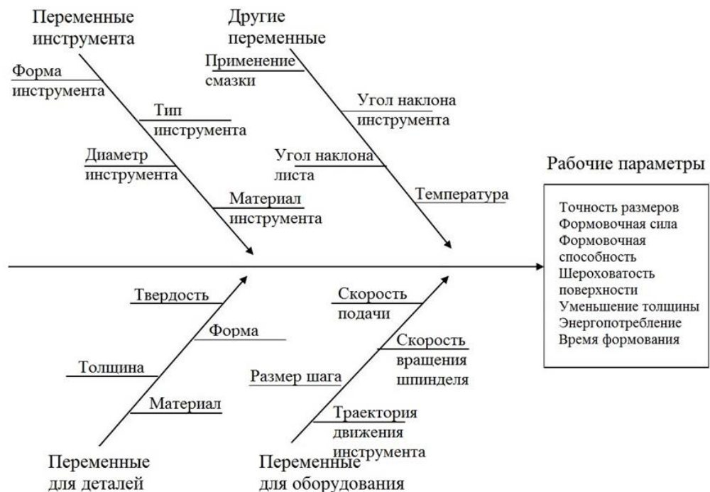
Рис. 6. Диаграмма Исикавы для технологии ротационной обработки
