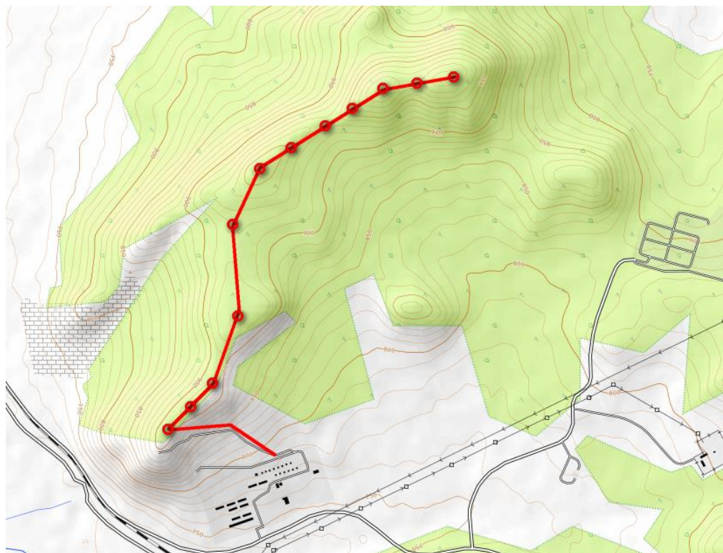
Рис. 1 – Оптимальная площадка для ветровых турбин вблизи вахтового поселка.
