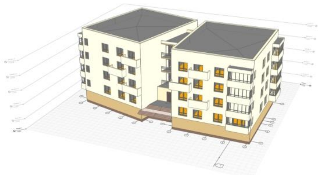
Рисунок 1 – Информационная модель здания из CLT панелей
