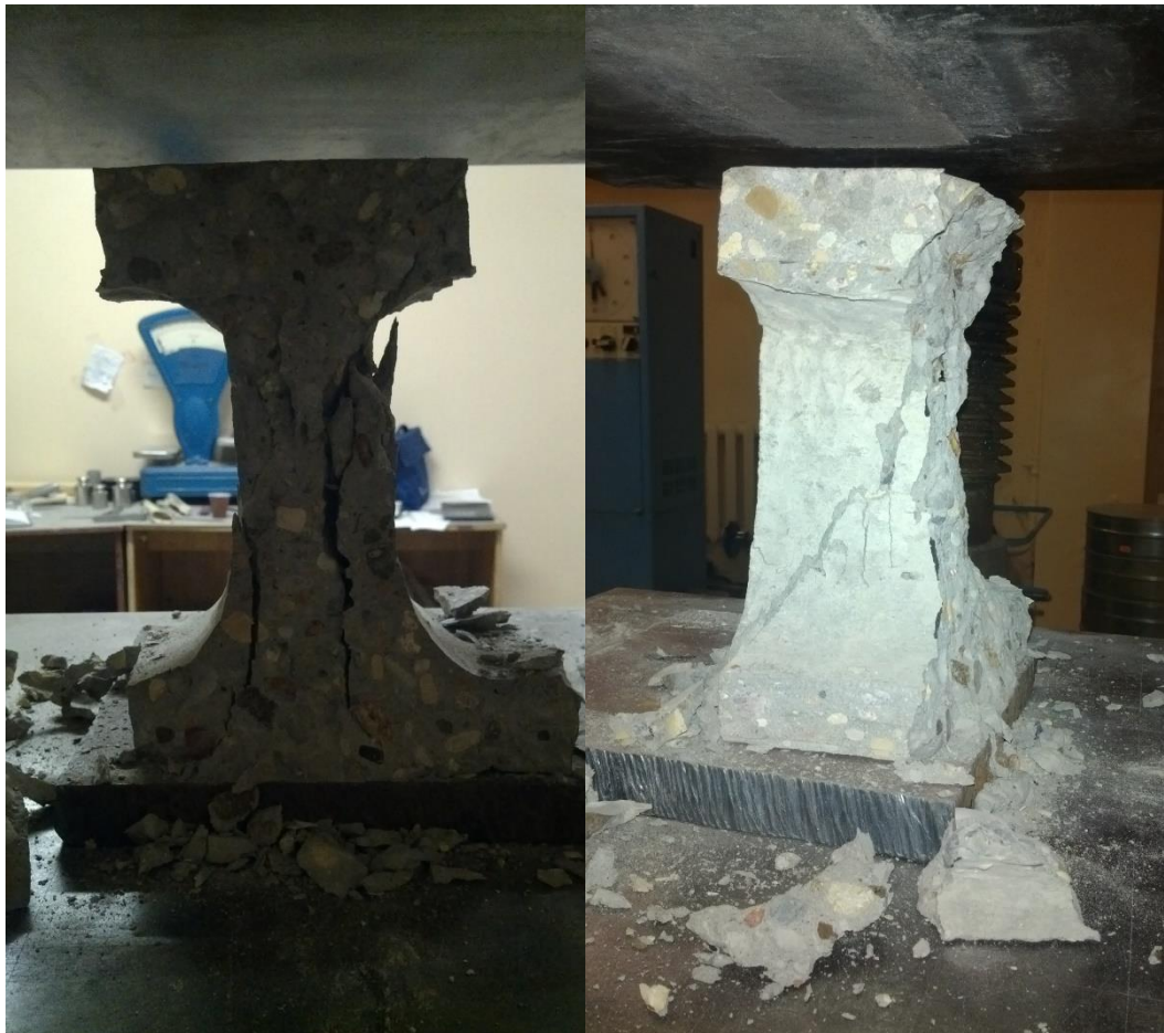
Рисунок 2 - Разрушение вертикального ребра плиты
