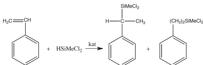
Соотношение продуктов  $\alpha$ - и  $\beta$ -присоединения, изменяется в широких пределах для катализаторов на основе комплексов платины  $[\text{PtCl}_2(\text{Et}_2\text{SO})_2]$  35/65,  $[\text{PtCl}_2(\text{SbPh}_3)_2]$  37/63,  $[\text{PtCl}_2(\text{AsPh}_3)_2]$  22/78,  $[\text{PtCl}_2(\text{PPh}_3)_2]$  0/100. В случае применения фосфиновых комплексов платины достигается 100 % селективность в отношении терминального продукта.
