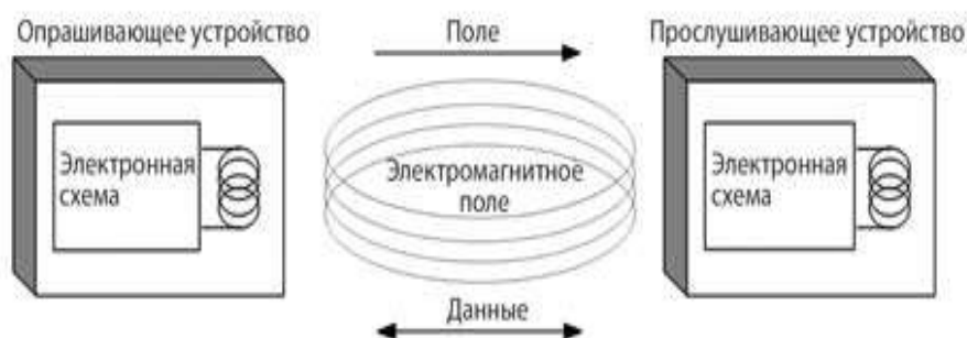
Рисунок 1 – Принцип обмена по технологии NFC
