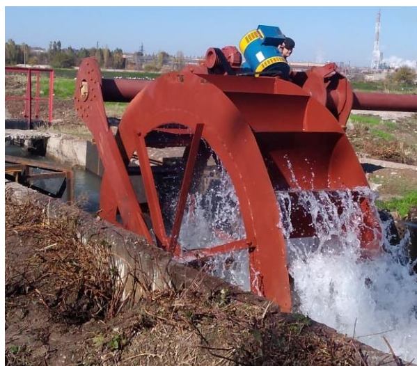
Рис. 1. Процесс испытания новой конструкции микроГЭС
