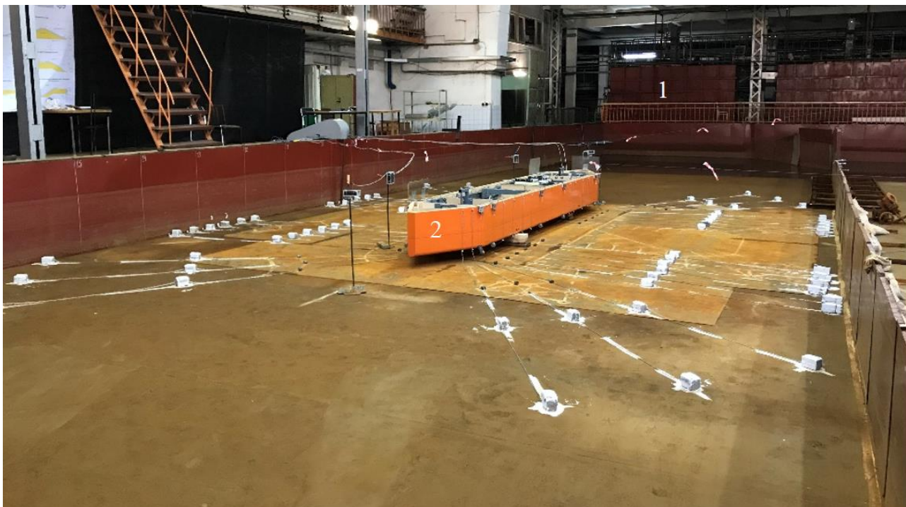
Рис. 1. Вид экспериментальной установки: 1 – волнопродуктор волн цунами; 2 – модель плавучего объекта
