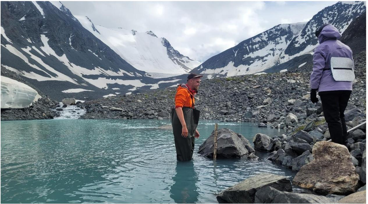
Рис. 15. Установка речного водомерного поста на озере Билли.
