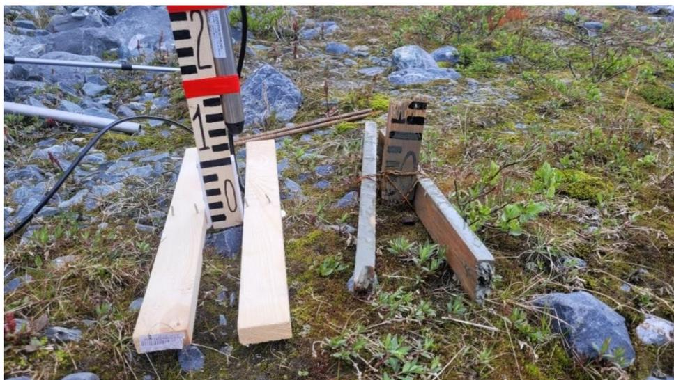
Рис. 14. Внешний вид водомерных реек, используемых в 2023 году (слева) и в 2022 году (справа).
