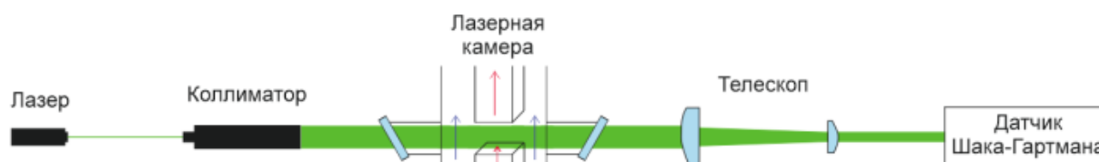
Рис. 1. Стенд для исследования влияния параметров газового потока на расходимость проходящего ЛИ
