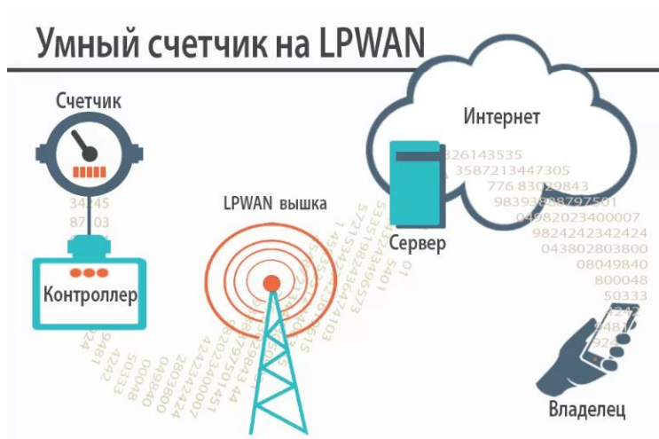
Рисунок 2. Схема работы счетчика с LPWAN
