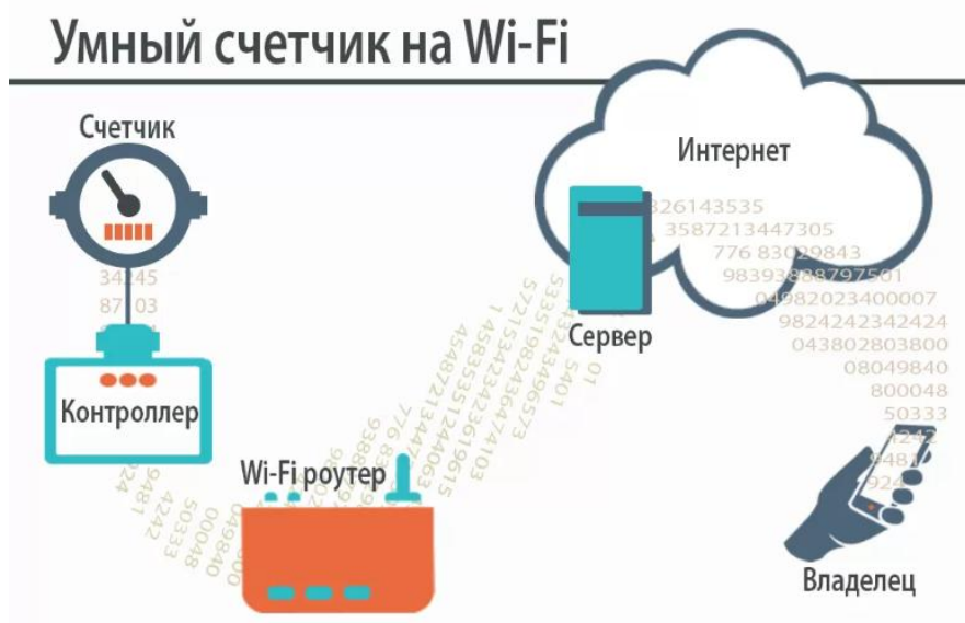
Рисунок 3. Схема работы счетчика воды с Wi-Fi
