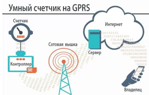
Рисунок 1. Схема работы счетчика воды с GPRS
