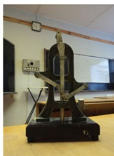
Рис. 6. Один из прямолинейно-направляющих механизмов. Параллелограмм Уатта.
