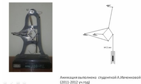
Рис. 7. Механизм Липкина-Посселье. Один из точных прямолинейно-направляющих механизмов.
