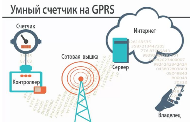
Рисунок 1. Схема работы счетчика воды с GPRS
