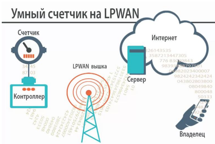
Рисунок 2. Схема работы счетчика с LPWAN
