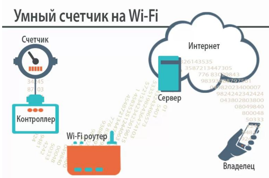
Рисунок 3. Схема работы счетчика воды с Wi-Fi
