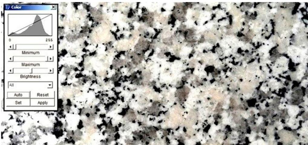
Рисунок 1. Цифровая фотография гранита. Размер поля зрения 15 см. На врезке – окно регулировки контраста изображения, составлено автором
