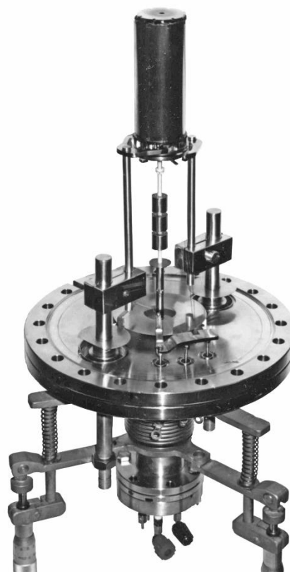
Рис. 5. Общий вид испарителя [45]. Вакуумная печь и микрометрические регуляторы, смонтированные на фланце испарителя
