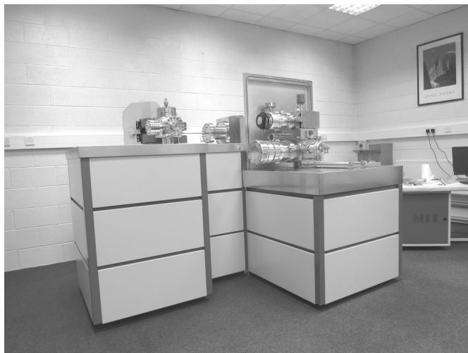
Рис. 7. Внешний вид магнитного масс-спектрометра для высокотемпературных термодинамических исследований с эффузионной камерой Кнудсена фирмы Mass Spectrometry Instruments Ltd., Великобритания [64]
