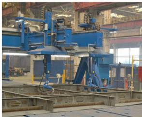
Линия изготовления плоских секций с роботизированной сваркой (2 робота)
