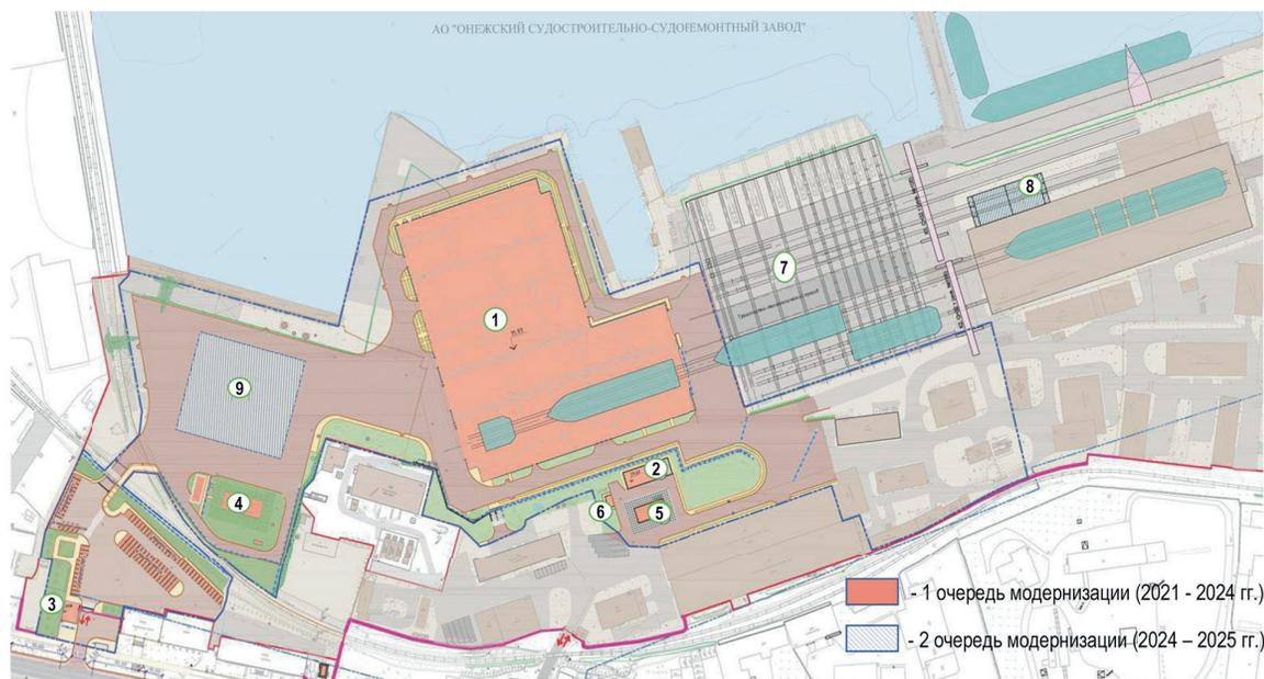
1-Блок корпусных цехов; 2-Блок-контейнерная компрессорная станция ВВД; 3-КПП; 4-Очистные сооружения; 5-Станция газификации технических газов; 6-Центр обработки данных; 7-Стапель и слит; 8-Камеры очистки и окраски секций; 9-Общезаводской склад.
