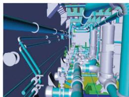
Позволит проводить разметку при монтаже труб и оборудования в помещениях судна и проверять их пересечения и наложения до непосредственного монтажа
