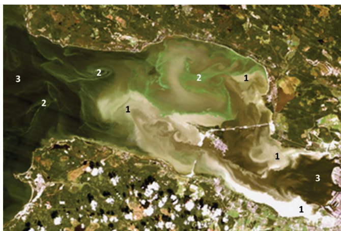
Рисунок 5.5 – Пример картины распределения загрязнения водной толщи Финского залива взвешенным веществом, как следствия проведения масштабных гидротехнических работ в Невской Губе, отделенной от Финского залива строящимся комплексом защитных сооружений (ситуация на 08.08.1986, отраженная сенсором LANDSAT) (фрагмент предоставлен Л.Л. Сухачевой), приводящих к резкому относительно кратковременному нарушению условий обитания планктонных и донных экологических группировок гидробионтов
