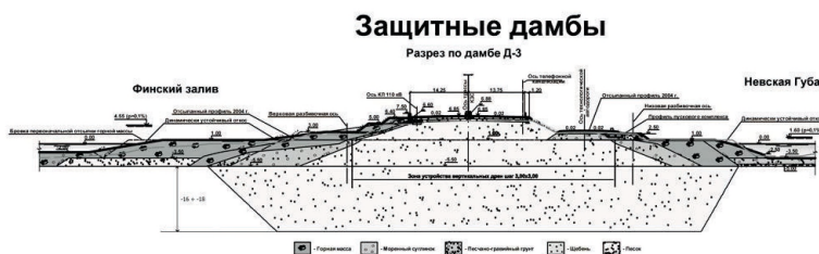
Рисунок 6.8 – Схема защитной дамбы. Характеристики защитной дамбы: - общая длина дамб - 23,4 км; - максимальная высота по гребню дамб - 6,5 м; - минимальная ширина по гребню - 30 м; - ширина в основании - до 160 м (дамба Д-5); - воздействие ветровых волн - до 3,5 м
