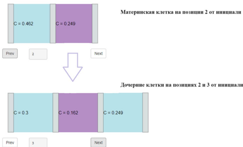
Рис. 2. Пример работы виджета VS-CD модели, реализующего пошаговую визуализацию делений во времени. Готовая к делению клетка выделена темным цветом
