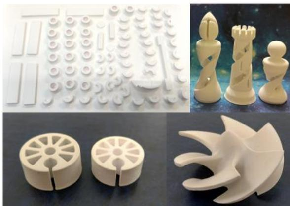
Рис. 2. Примеры изделий из керамики на основе оксида алюминия, полученных технологией цифровой обработки светом (DLP)
