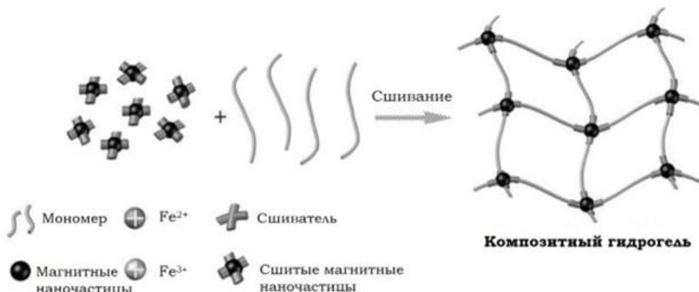
**Рис. 2. Схема синтеза композитного гидрогеля методом сшивания**
