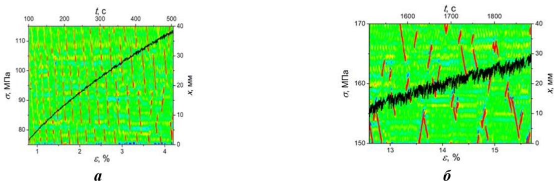
Рис.1. Участок диаграммы растяжения  $\sigma(\epsilon)$  аддитивного изготовленного сплава АМг5 в исходном состоянии, совмещенный с хронограммой X-t движения полос ПЛШ, на стадии линейного деформационного упрочнения (а) и стадии параболического деформационного упрочнения (б)
