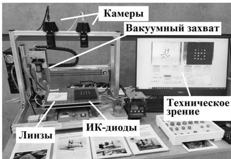
Рис. 1. Роботизированная система с техническим зрением
