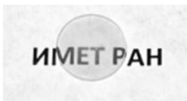
Рис. 1. Прозрачная керамика на основе оксида иттрия, полученная с использованием метода гелевого литья
