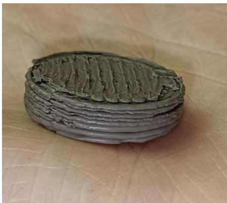
Рис 1. Экспериментальный образец печати (сырец)
