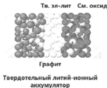
Рис. 1. Схема устройства твердотельного аккумулятора с композитными электродами
