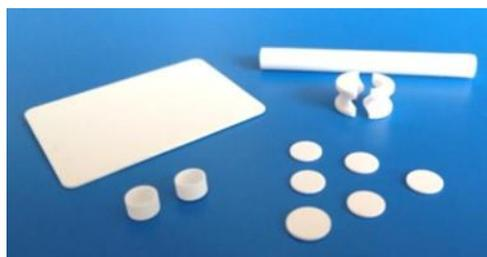
Рис. 1. Примеры изделий из керамики на основе оксида алюминия, полученных методом лазерной стереолитографии из пасты разработки НИЦ «Курчатовский институт» - ВИАМ
