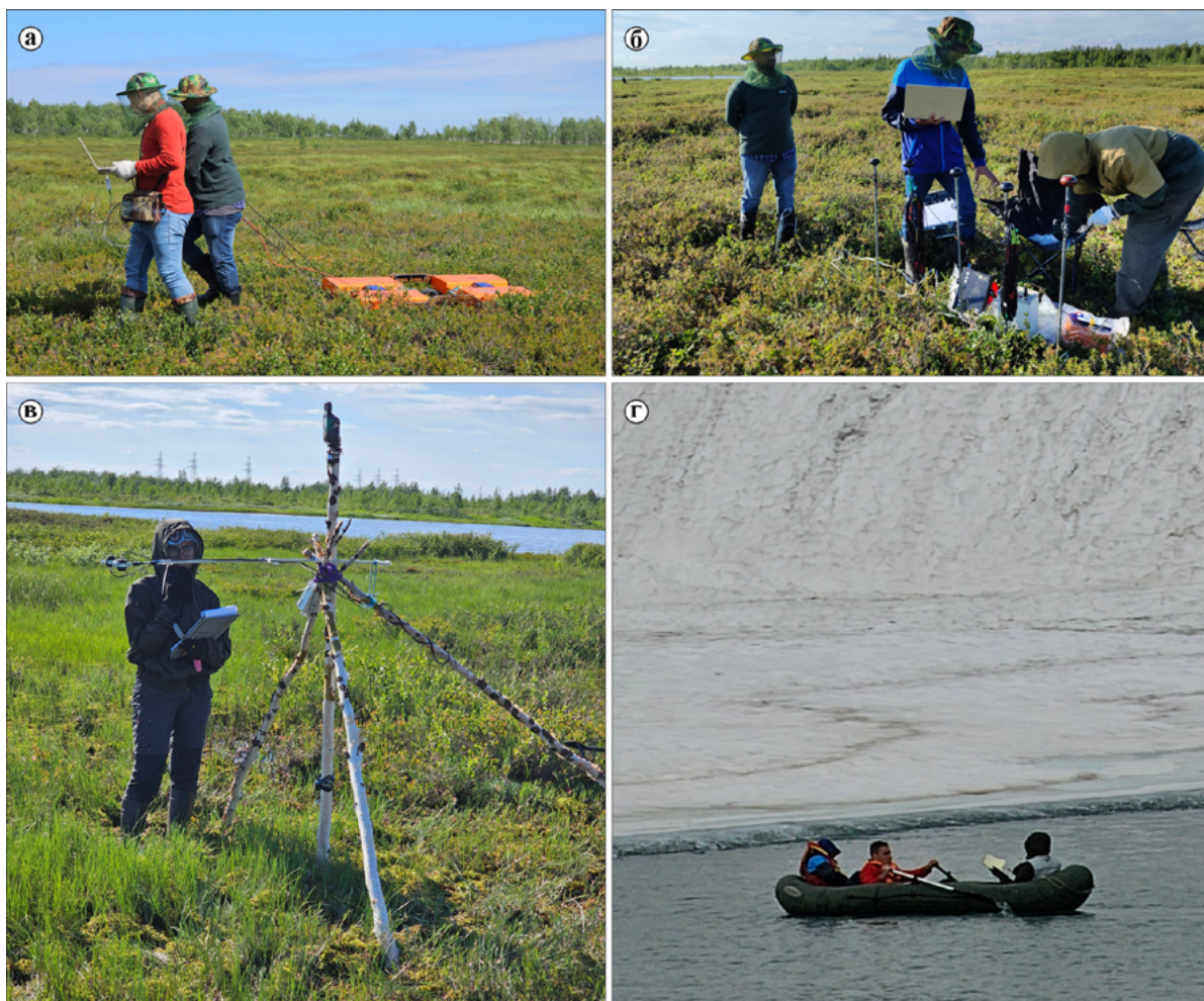
Рисунок 2. Процесс выполнения георадарных (а) и электроразведочных работ (б), актинометрический и термометрический комплекс (в), измерения глубин озера (г). Фотографии авторов, июль 2024 г.
