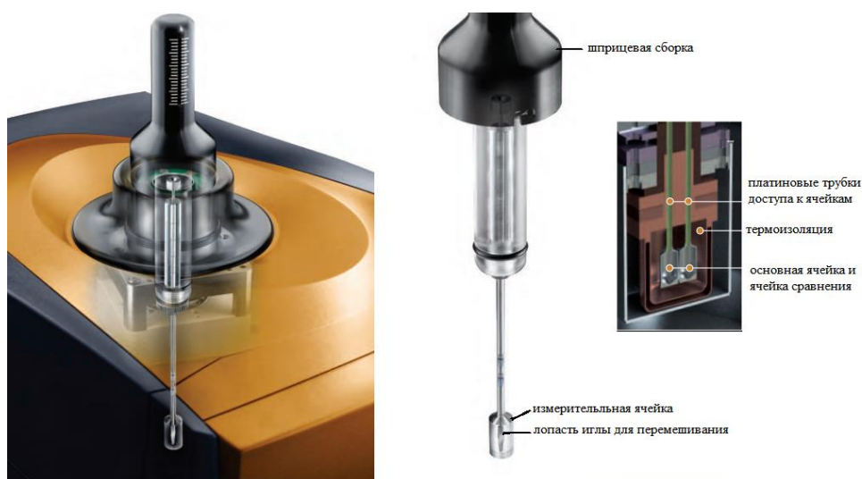
Рисунок 2.26 – Устройство прибора Nano ITC 2G
