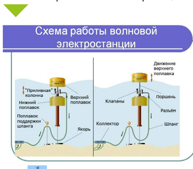
Рис. 5. Схема работы волновой электростанции
