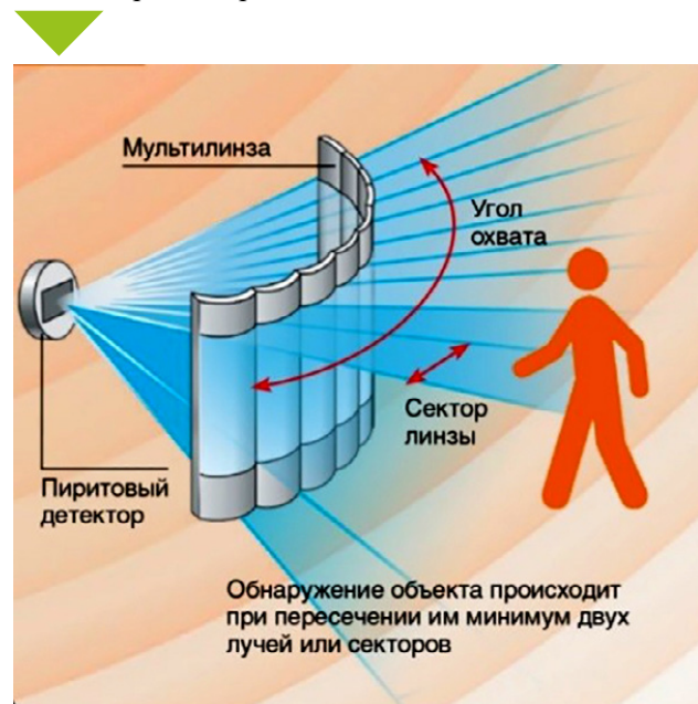
Рис. 3. Принцип работы датчика движения
