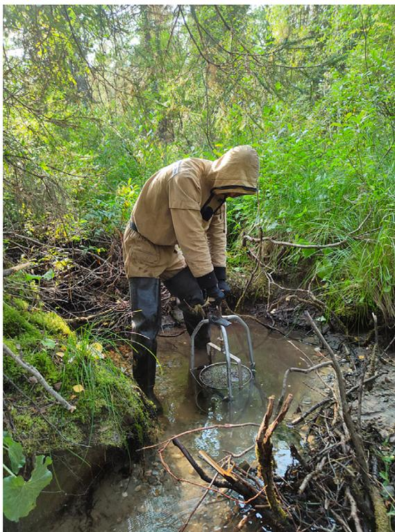
Рис. 2. Обогащение пробы на отсадочной машинке (джиге)
