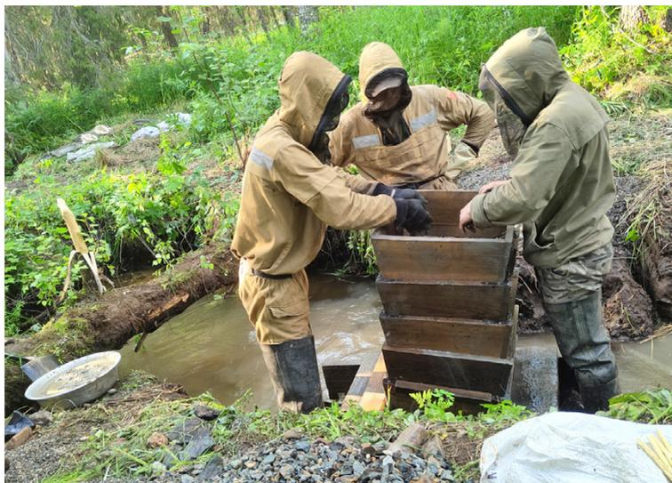
Рис. 1. Разделение пробы на шесть фракций при помощи шейкера. Остальные фракции обогащаются на ручной отсадочной машинке (джиге)
