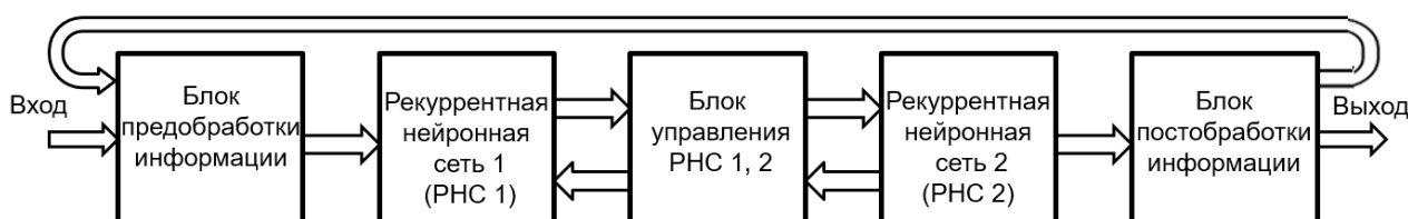
Рис. 1. Схема нейроморфной интеллектуальной машины с непрерывным обучением
