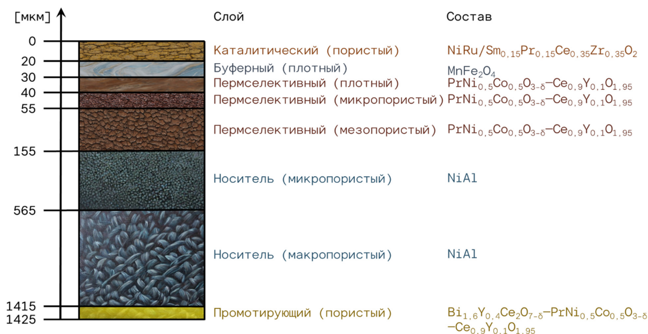
Рисунок 1. Послойная схема кислородпроводящей мембраны.
