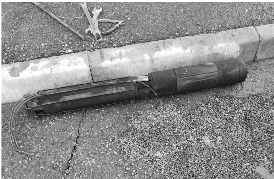
Рис. Погружной насос, покрытый минеральным осадком
