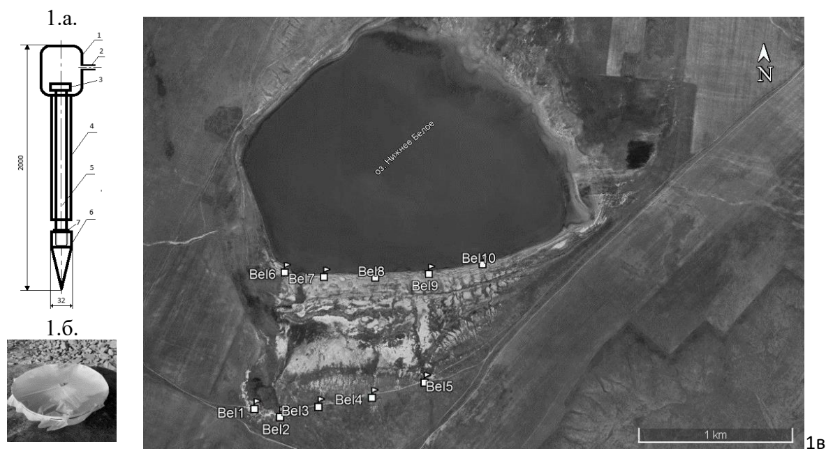
Рис. 1. Пробоотборники для исследования газового состава зоны аэрации (1.а.) и потока аэрозолей из почвогрунтов (1.б.), схема опробования газового и аэрозольного потоков в районе озера Нижнее Белое. Условные обозначения: 1- приемная камера, 2 – штуцер для откачки воздуха, 3- шток, 4- труба, 5- паз, 6- конус, 7- резьбовое соединение; Bel1- Bel10 –места опробования потоков газа и аэрозолей.
