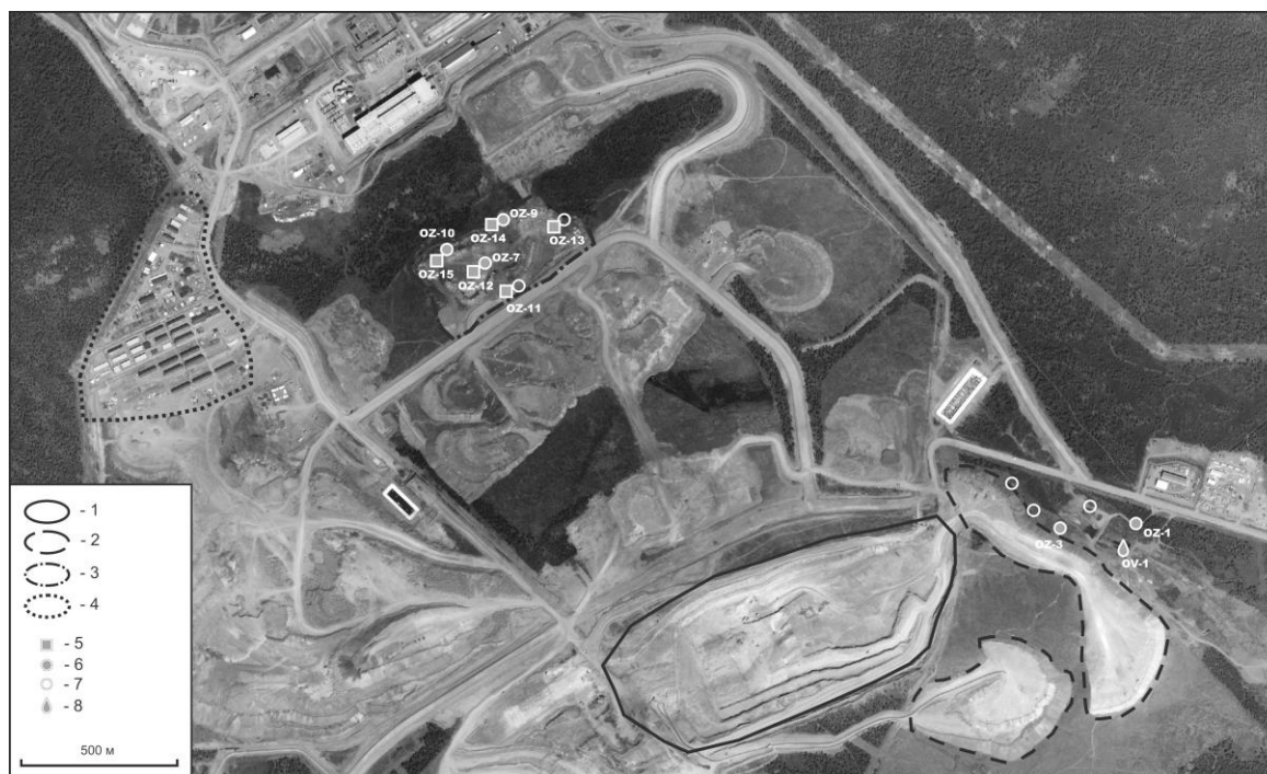
Рис. 1. Схема опробования отходов добычи Озерного полиметаллического месторождения. Условные обозначения: 1- карьер, 2- вскрышные породы, 3- склад окисленных руд, 4- поселок, 5 – места опробования атмосферных осадков, 6- конденсационных вод, 7- не обнаружен конденсат, 8- временный водоток.
