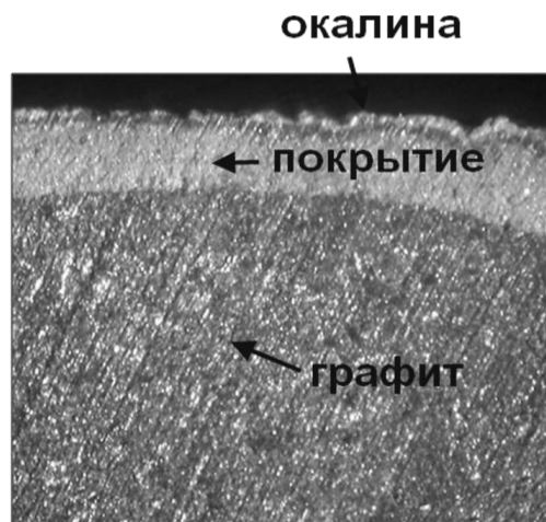
Рис. 2. Поперечный срез образца графита с покрытием после термообработки при 1300°C в течение 3 часов ZrB_2-SiC .
