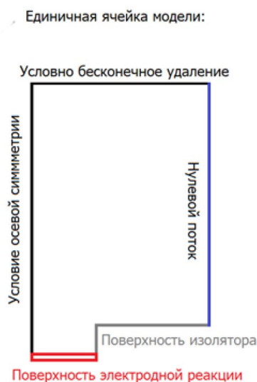
Рисунок 4 - Геометрическая схема углубленных ультрамикроэлектродов
