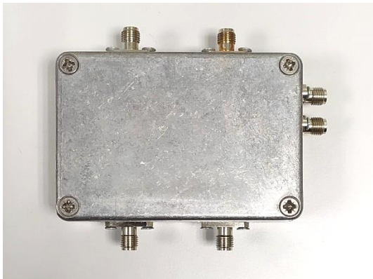
Рис. 5. Конструкция полупроводникового малошумящего дифференциального усилителя постоянного тока (фото)
