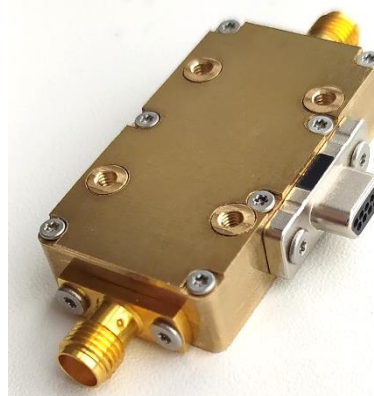
Рис. 1. Конструкция криогенного полупроводникового малошумящего СВЧ-усилителя. Габаритные размеры 40×22×10,5 мм (без учета разъемов)
