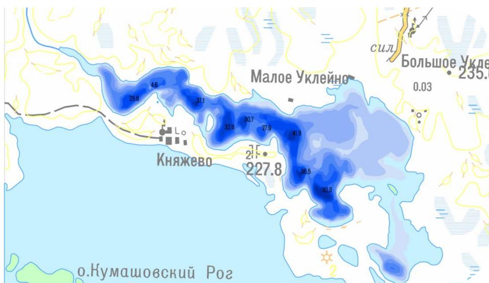
Рисунок 2. Батиметрическая схема оз. Уклейное в ПО «НЕВА».
