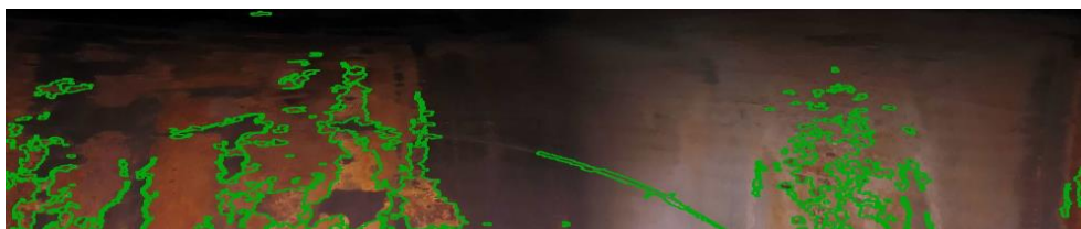
Рис. 5. Обнаружение дефектов на полученном изображении
